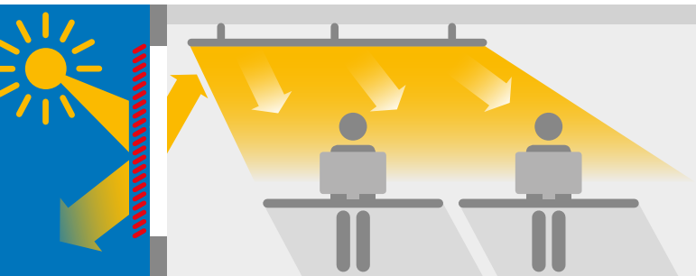
Transmission de la lumière vers le fond de la pièce avec Atlantic Glow lorsque le brise-soleil est activé.
